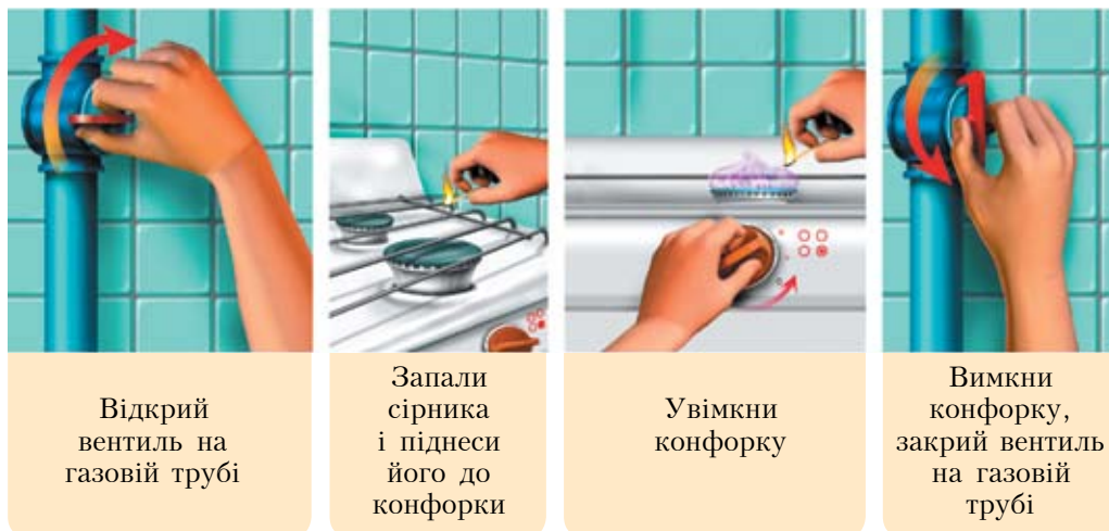
Мал. 39. Порядок вмикання і вимикання газової конфорки
