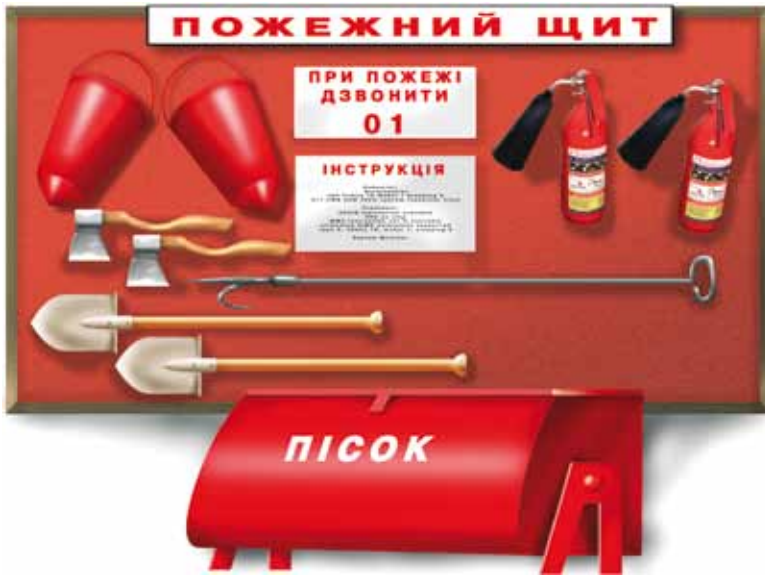
Рис. 25. На пожарных постах находятся огнетушители, ведра, топоры, лопаты, крюки, лестницы, ведра с водой, которые зимой заменяют ящиками с песком
